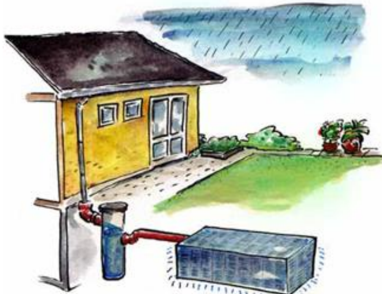
Opbygning af faskine af plastikassette ved parcelhus
